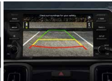
Monitor de visión trasera (RVM) Cuando la transmisión está en reversa, la pantalla de audio de 8 pulgadas visualiza el área detrás del Sonet, con directrices de estacionamiento superpuestas en la imagen del video.
